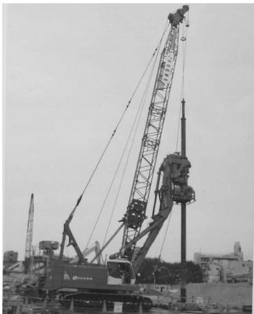
图 1 斜塔动力头旋挖钻机
