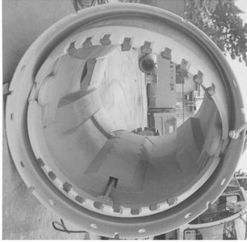
图 4 与旋挖钻机配套使用的钻头
