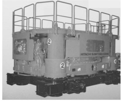
图 5 全套管全圆周回转钻机
