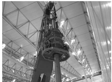
图 3 配有油管盘架和液压回转接头的旋挖钻机
