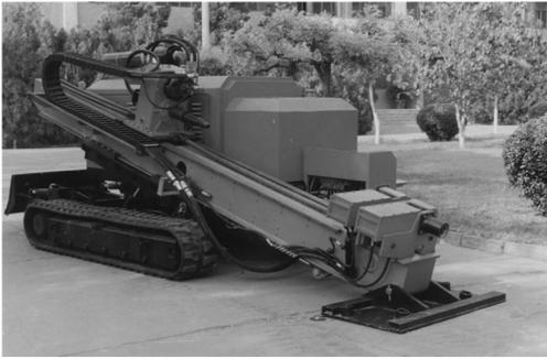
图 2 GBS-20L 型非开挖铺管钻机
