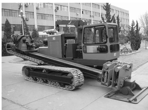
图 1 GBS-35 型非开挖铺管钻机
