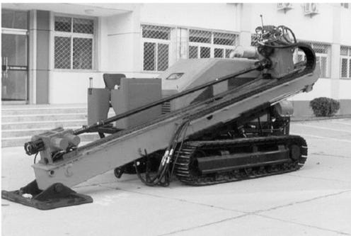
图 3 GBS-28 型非开挖铺管钻机
