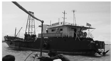
图1 海上水力反循环实时取样钻探全景
