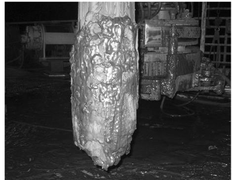
图 1 DK34 井 5 号钻头出井泥包图片
