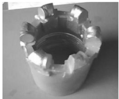
图2 使用前孕镶金刚石复合片钻头
