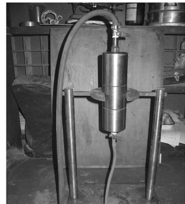
图 1 渗透恢复率测定仪图片
