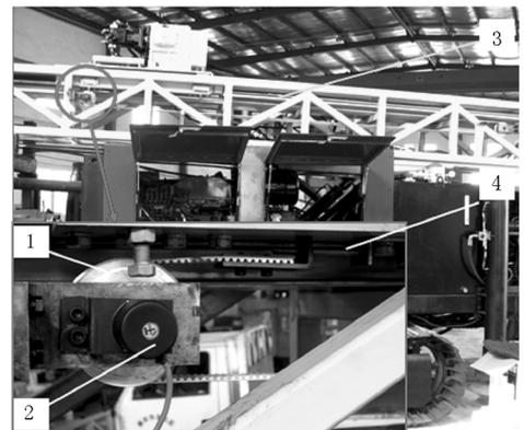
图 4 光栅编码器和同步带实物安装图
