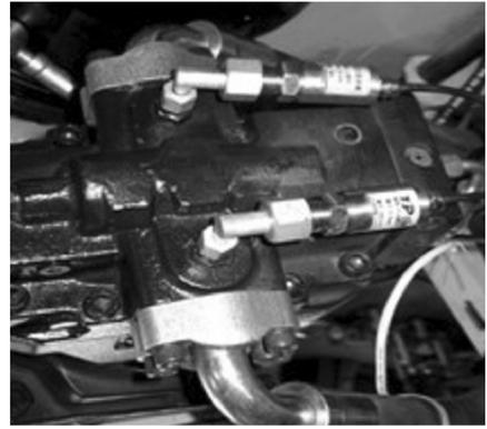
图5 液压马达压力传感器安装图
