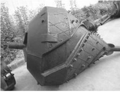
图1 挤压式钻头
