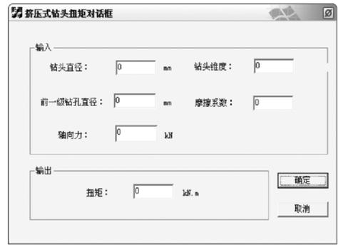
图 3 挤压式钻头扭矩拉力对话框
