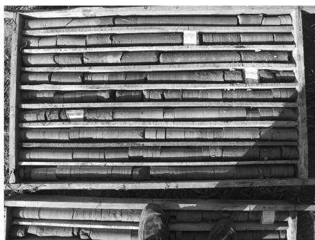
图 2 SA75<sup>+5</sup> 绳索取心钻具采取的岩心
