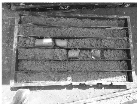
图 1 普通双管钻具( $\varnothing 91\text{ mm}/\varnothing 60\text{ mm}$ )采取的岩心
