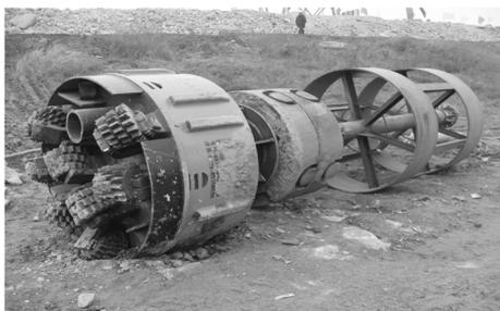
图1 重力式导向防斜钻具照片
