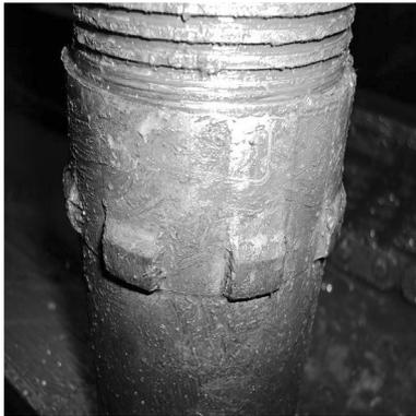
图3 保径条扩孔器磨损情况
