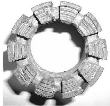
图2 使用后的孕镶金刚石钻头
