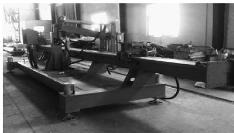
图 1 BG 型钻杆排放设备图
