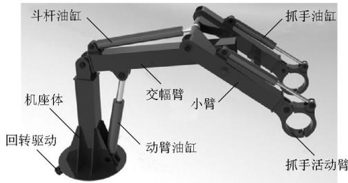
图 2 机械手结构设计图
