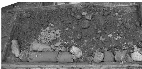
图6 ZK8721孔钻遇的砂质松散地层
