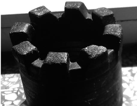
图6 防糊梯齿金刚石钻头
