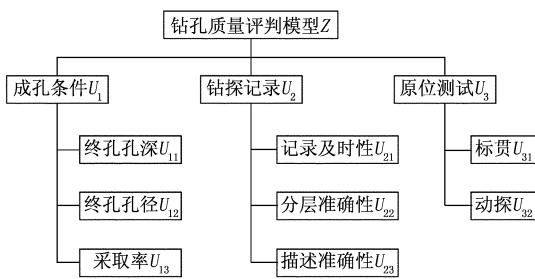
图1 钻孔质量“三合一”结构质量评价体系
