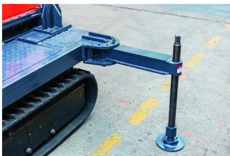
图4 斜孔钻进支腿状态
