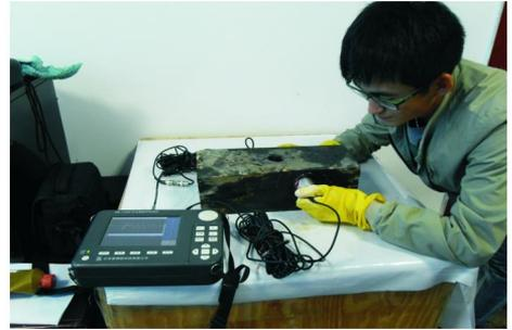
图 5 进行超声波检测
