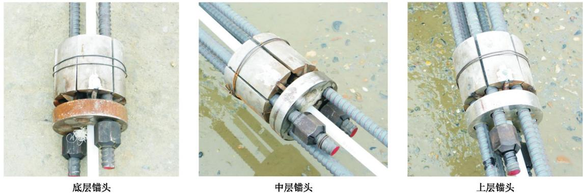
图 8 组装完成的自锁式内锚头
