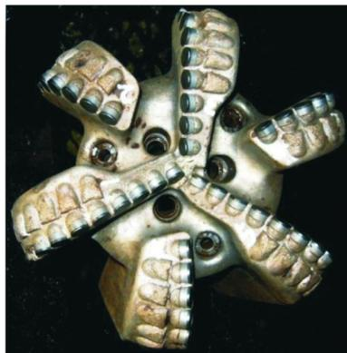
图2 在塔里木油田钻进 177 m 后的 FuseTek 613 钻头
