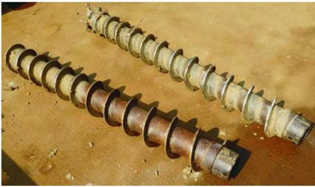
图8 中空螺旋钻杆
