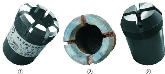
图 3 120ZK1 钻孔事故处理中使用的偏斜钻头
