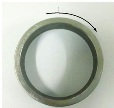
图5 XJY850 管体周向硬度测试样品实物(顺时针方向硬度)
