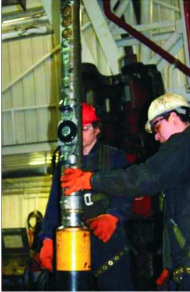
图 15 组合式地层动态测试仪(MDT)
