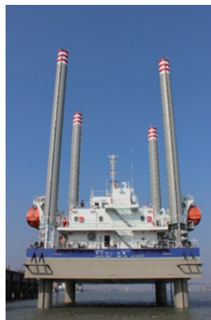
图1 35 m水深自升式勘探平台
