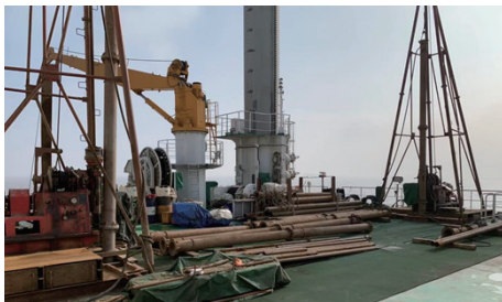
图2 平台双机位布置结构
