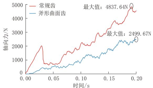
图10 压入仿真的PDC齿轴向力对比
