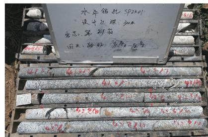
图 2 水平钻孔岩心
