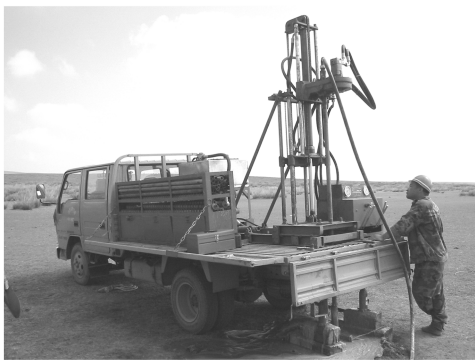
图2 CQK-50型车载化钻机全貌
