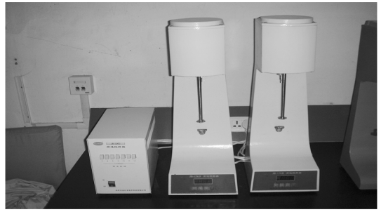
图 5 单轴变频高速搅拌机正在中海油服塘沽基地实验室使用
