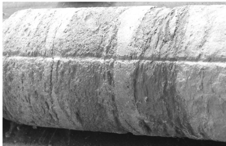
图 5 定向取心取出的带刻痕岩心
