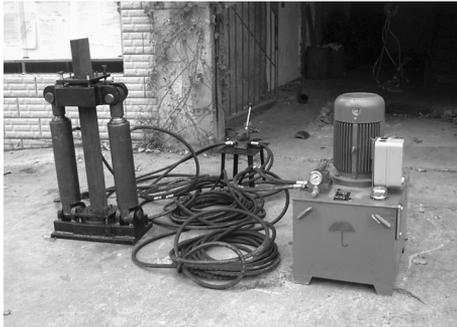
图 1 YBG 系列液压拔管机实物图片
