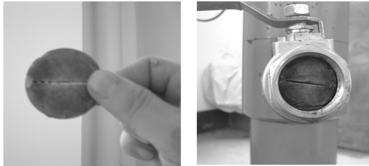
图 3 1 mm 缝板防漏实验
