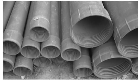
图 1 PVC-U 塑料井管(扩口螺纹)
