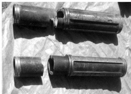
图2 试验中断裂的活塞
