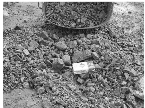
图 3 采用反循环工艺清除的钻屑
