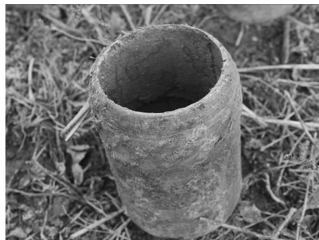
图 1 磨损割断的扩孔器
