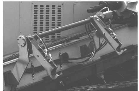
图13 旋转结构输送钻杆的结构图片
