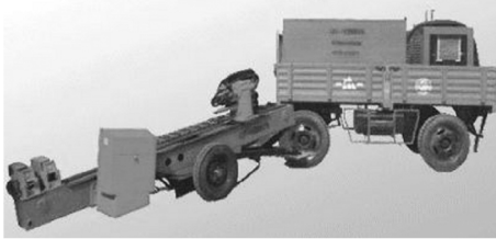
图11 拖车式底盘装载的分体式钻机图片
