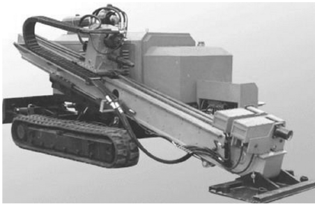
图10 履带底盘装载的钻机图片
