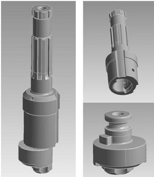
图 2 偏心钻具几何模型
