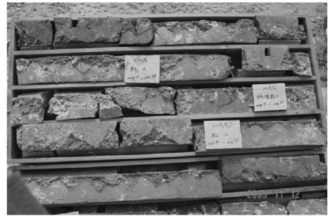
图4 用改进后的异径接头钻具取得的部分粘土层岩心
