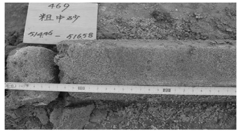
图3 用改进后的异径接头钻具取得的部分砂层岩心
