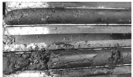
图2 断层泥孔段的岩心样品
