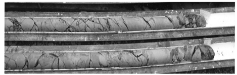
图1 地层裂隙极其发育的岩心样品
