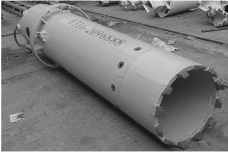
图 8 双壁套管柱(套管靴切削具为可更换的焊有硬质合金的切削齿)
