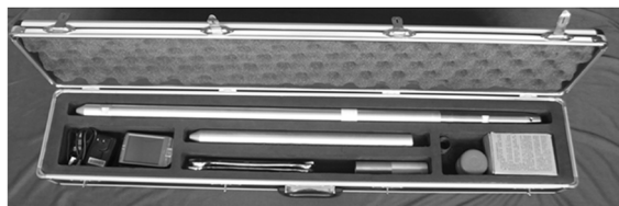
图 1 基于 PDA 和蓝牙的无缆钻孔测斜仪
