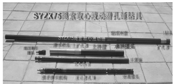
图 3 SYZX75 绳索取心液动锤实物图片
