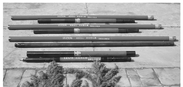
图 4 SYZX96 绳索取心液动锤实物图片
