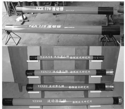
图 2 YZX 系列液动锤实物图片
