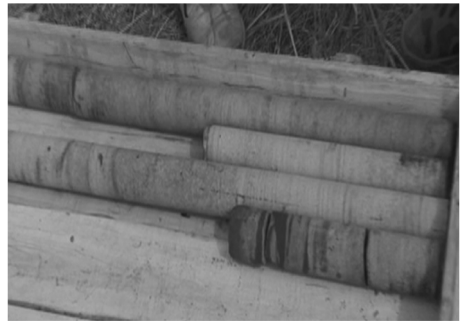
图 2 空气钻进取出的岩心
