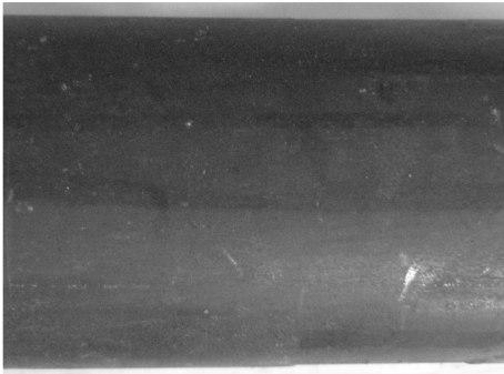
图4 中频感应调质后的钻杆表面情况
