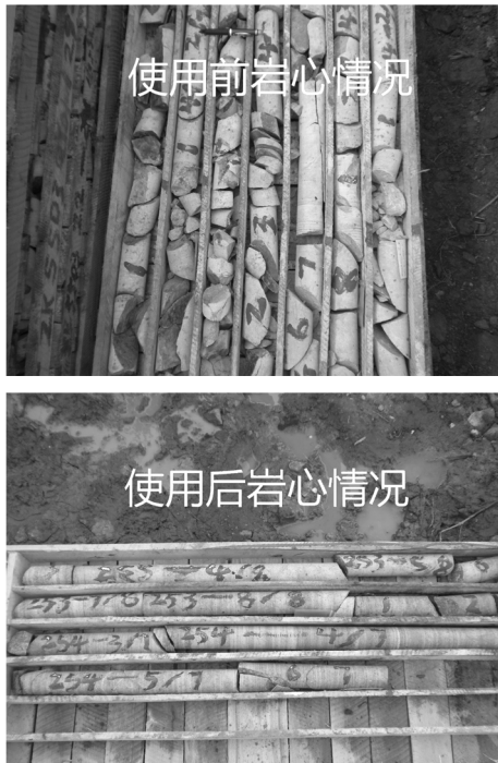
图2 微泡沫钻井液使用前后岩心对比图
