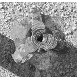
图4 严重磨损的刮刀钻头
