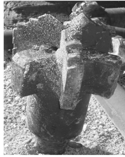
图3 新的刮刀钻头
