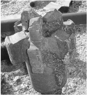
图2 严重磨损的刮刀钻头
