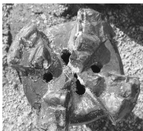
图5 磨损的 PDC 钻头
