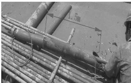
图2 潜孔锤钻具改进
