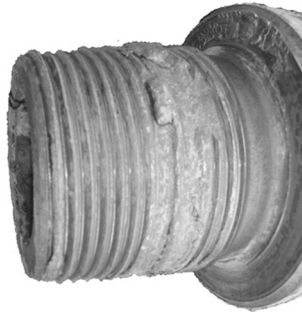
图3 由于缺乏螺纹脂而使螺纹粘扣
