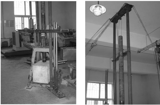
图7 潜孔锤反循环钻头碎岩模拟实验台
