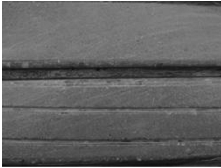
图6 R=6 mm的倒角切缝
