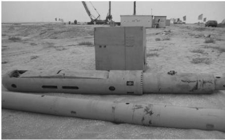
图 2 挤扩施工设备
